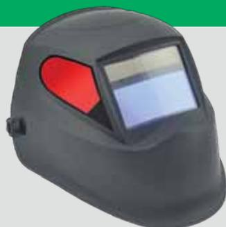
Maschera a casco per saldatura, autoscurante, schermo a cristalli liquidi LCD, grado di oscuramento DIN 11, 2 sensori, corpo in plastica, calzata regolabile. Con batterie agli ioni di litio, ricaricabili tramite celle solari incorporate. Adatta per saldatura ad elettrodo e filo continuo
