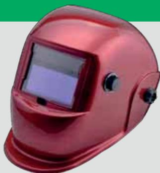
Maschera a casco per saldatura, autoscurante, schermo a cristalli liquidi LCD, grado di oscuramento regolabile DIN 9-11, 2 sensori, corpo in plastica, calzata regolabile, funzione molatura. Con batterie agli ioni di litio, ricaricabili tramite celle solari incorporate. Adatta per saldatura ad elettrodo, TIG e filo continuo
